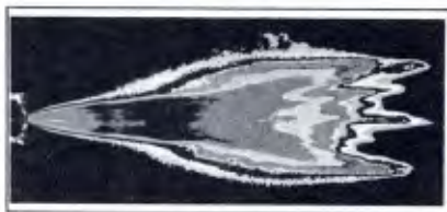
Este é o raio-x do spray de um bico injetor em perfeitas condições. É a quantidade de óleo diesel exata para o seu motor.
