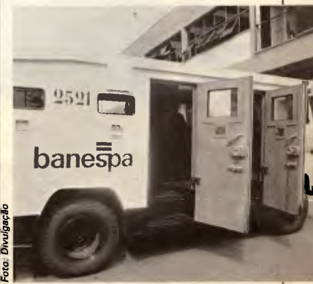
A blindagem contém aço e aramida
