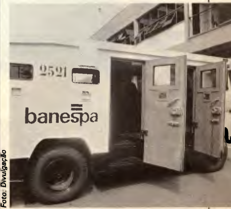
A blindagem contém aço e aramida
