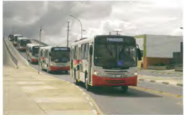
680 Nm e pbt de 15.000 kg. Os veículos fornecidos à empresa Princesinha do Sertão possuem carroceria Mascarello e são equipados com eixos Meritor e direção hidráulica ZF Servocom.
