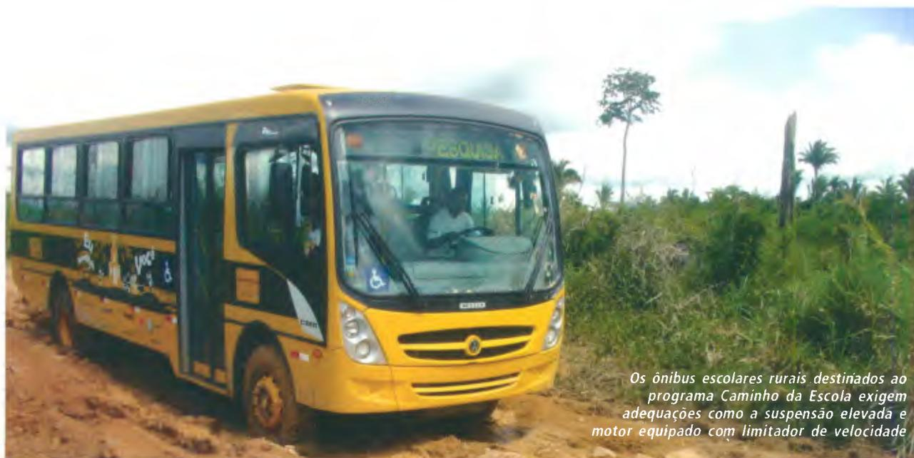
*Os ônibus escolares rurais destinados ao programa Caminho da Escola exigem adequações como a suspensão elevada e motor equipado com limitador de velocidade*
