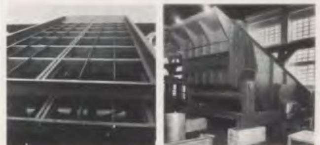
Peneira Faço: conforme a malha tem a capacidade de 100 a 300 m<sup>3</sup>/h na classificação final de britagem.
