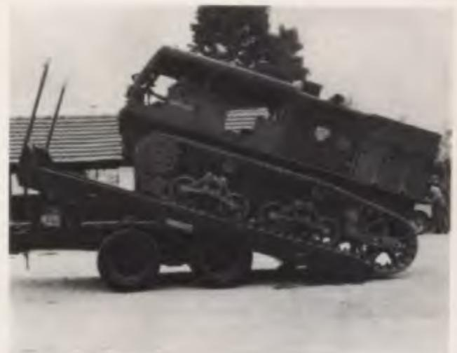
A inclinação é controlada por cilindros hidráulicos.
