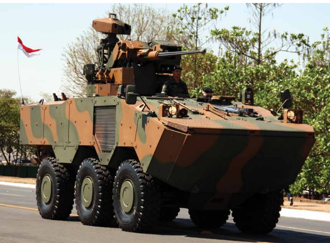
O Guarani transporta até 11 pessoas, tem peso total de 18 toneladas e motor de 383 cv
