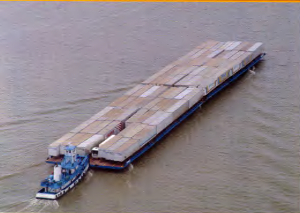
Empurrador em operação no rio Madeira, entre Manaus(AM) e Belém(PA): balsa com capacidade para 80 semi-reboques e 80 horas de viagem
