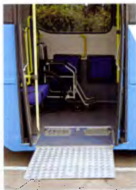
Piso no nível da calçada
