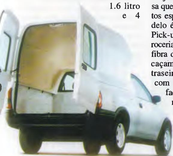
O pequeno furgão da GM é derivado do Corsa Pick-up e tem porta traseira de duas folhas com acesso facilitado ao compartimento de carga
