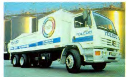
A Unidade Móvel de Calibração, da Toledo do Brasil (foto), formada por 4 caminhões com guincho, motor de alta potência, pesos e equipamentos de testes, pretende modernizar o sistema de calibração de balanças rodoviárias e ferroviárias no País.
