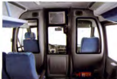
Cabine do motorista fica separada do salão de passageiros por parede
