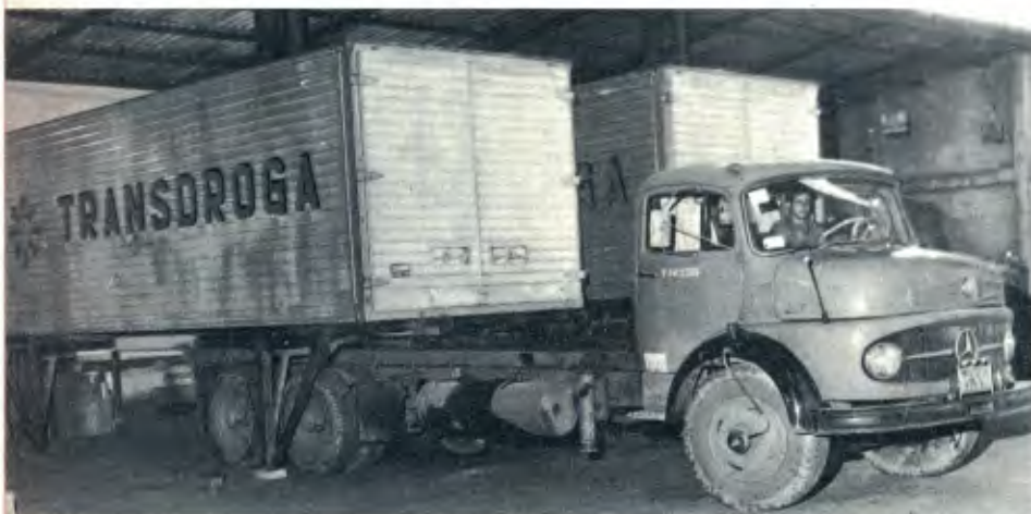
"Slidetainer": cofre de carga tipo contêiner, faz o caminhão render mais.
