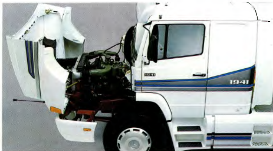
Capô basculável, para fácil acesso à manutenção.
