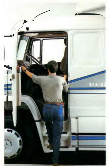
Acesso ao interior da cabina facilitado por portas altas e largas, alças laterais e degraus bem dimensionados.
