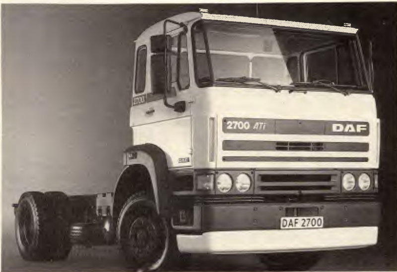
O DAF-2700 emite o máximo de 9 g de óxidos de nitrogênio por kW/h
