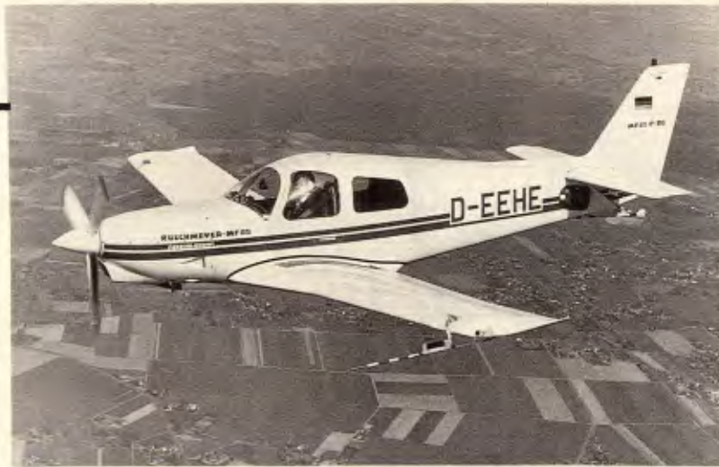
O Ruschmeyer MF-85: com motor Porsche e capacidade para três passageiros
