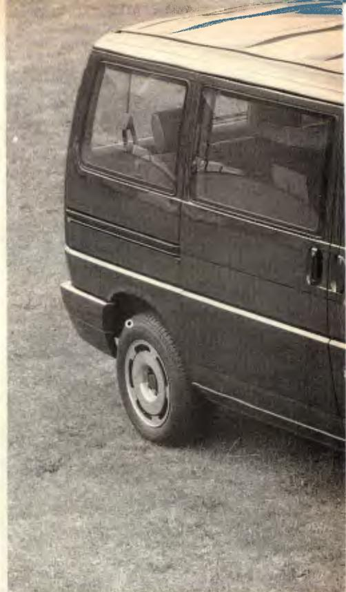
ce melhor acesso ao compartimento de carga se comparado aos modelos anteriores. A VW desenhou dois tipos de traseira: uma *hatch-back*, para a versão de passageiros, e uma com portas verticais, para as versões de carga. A porta lateral, na direita do veículo, é do tipo deslizante. Uma segunda porta lateral na esquerda pode ser pedida como opcional.
