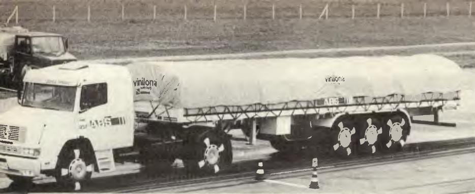
*Com ABS/ASR, o motorista consegue reduzir a velocidade antes de contornar o obstáculo; sem o equipamento, o motorista perde a direção e o veículo derrapa*
