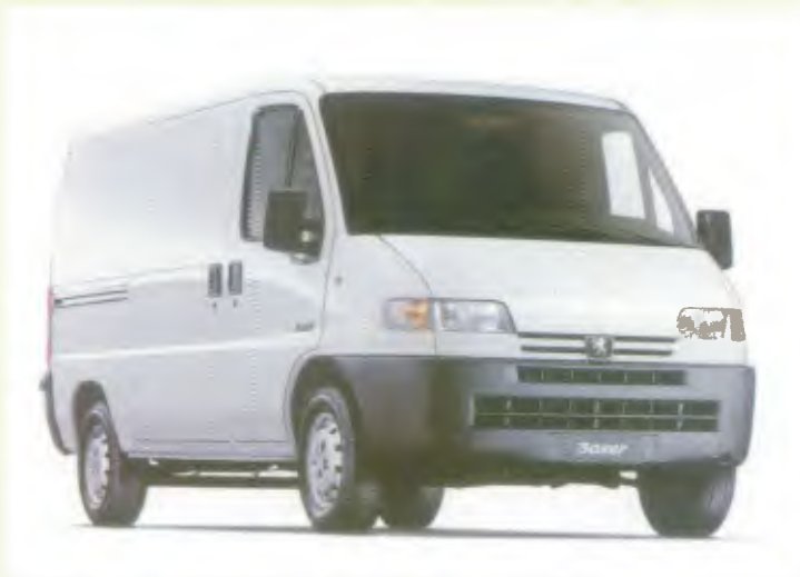
Modelo: Boxer Furgão Curto Entre-eixos: 4.655 mm, 5.055 mm Motor: 103 cv a 3.600 rpm PBT: 3.300 kg
