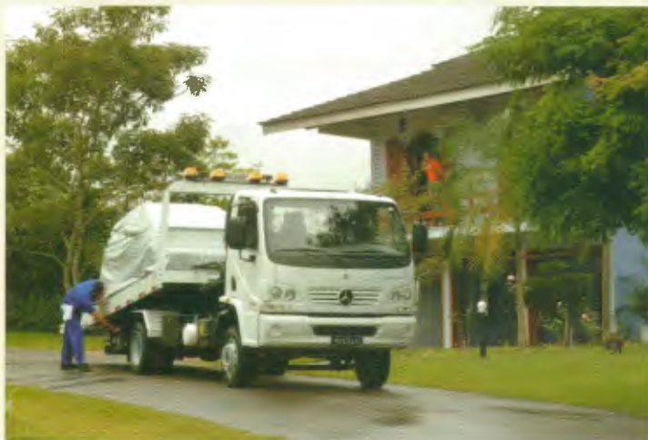
Modelo: Accelo 715 C Entre-eixos: 3.100 mm, 3.700 mm Motor: 156 cv a 3.800 rpm PBT: 7.000 kg
