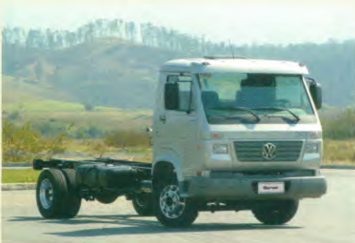
Modelo: 8.150 E 4x2 Entre-eixos: 2.850 mm/3.300 mm, 3.900 mm/4.300 mm Motor: Cummins Interact 4.0, 150 cv a 2.500 rpm PBT: 8.150 kg
