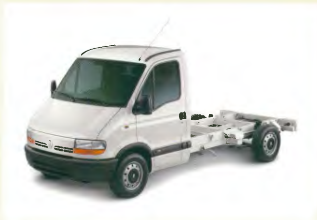
Modelo: Master Entre-eixos: 3.078 mm Motor: 114,3 cv a 3.600 rpm PBT: 3.500 kg
