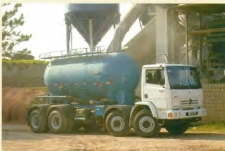
Modelo: 2423 B 8x4 Entre-eixos: 3.600mm+1.350 mm Motor: 231 cv a 2.300 rpm PBT: 16.300 kg 32.000 kg
