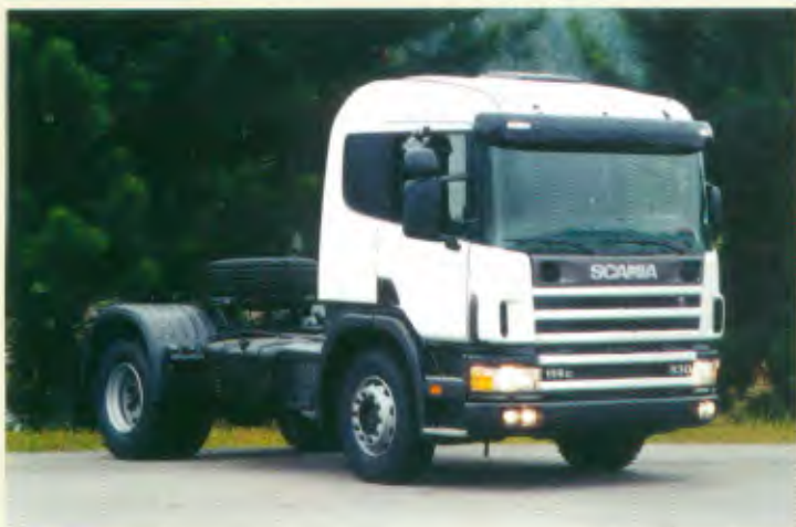
Modelo: 114G 4x2 Entre-eixos: 4.700 mm Motor: DSC 11 07, 330 cv a 1.600/1.900 rpm PBT: 18.200 kg
