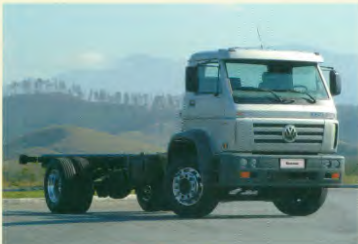
Modelo: 8.150 E 4x2 Entre-eixos: 2.850 mm/3.300 mm, 3.900 mm/4.300 mm Motor: Cummins Interact 4.0, 150 cv a 2.500 rpm PBT: 8.150 kg
