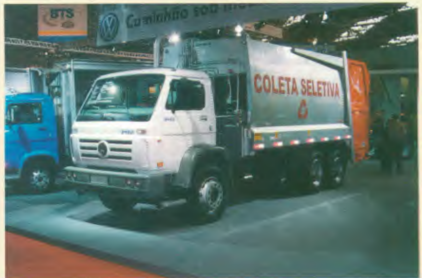
Modelo: 17.220 6x2 Entre-eixos: 3.560 mm/4.340 mm, 4.800 mm/5.207 mm Motor: Cummins 6CTAA, 218 cv a 2.200 rpm PBT: 16.000 kg
