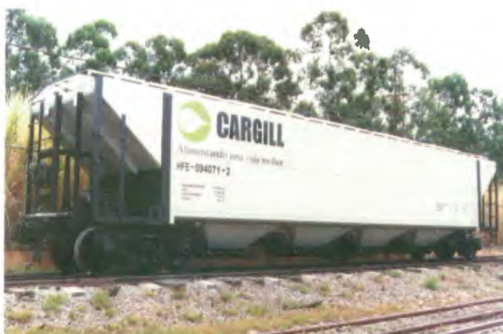
Vagão Hopper para transportar grãos e fertilizantes
