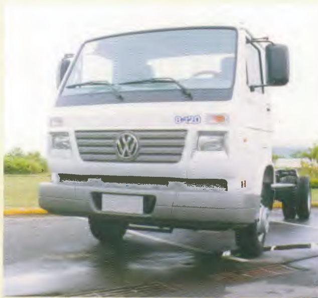
Modelo: 8.120 4x2 Entre-eixos: 3.900 mm, 4.300 mm Motor: MWM 4.10TCA, 120 cv a 2.600 rpm PBT: 7.700 kg
