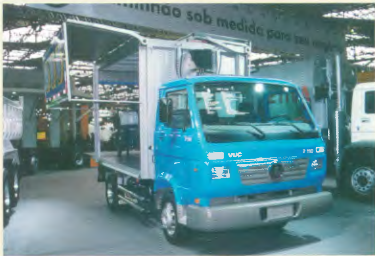
Modelo: 7.110 VUC Entre-eixos: 2.850 mm/3.300 mm, 3.900 mm/4.300 mm Motor: MWM 4.10TCA, 120 cv a 2.600 rpm PBT: 6.900 kg
