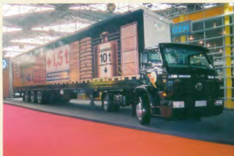
Modelo: 18.310 Titan Tractor 4x2 Entre-eixos: 3.560 mm Motor: Cummins 6CTAA, 276 cv a 2.200 rpm PBT: 23.000 kg PBTC: 35.000 kg
