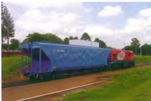
Protótipo de vagão Hopper da Randon em teste
