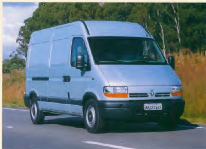
Modelo: Master Entre-eixos: 3.078 mm Motor: 114,3 cv a 3.600 rpm PBT: 3.500 kg
