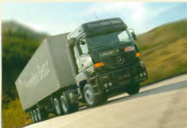
Modelo: 1944 S 6x2 Entre-eixos: 3.300 mm+1.295 mm Motor: PBT: 30.100 kg PBTC: 45.000 kg
