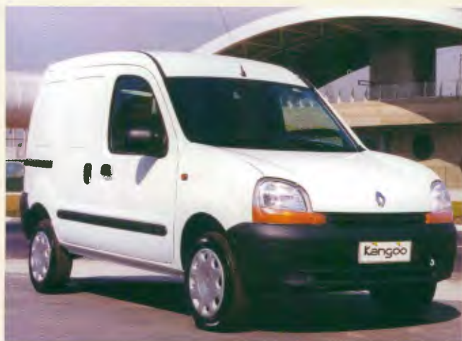
Modelo: Kangoo Express 4x2 Entre-eixos: 2.600 mm Motor: 1.0, 70 cv a 5.750 rpm, 1.6, 95 cv a 5.000 rpm PBT: 470 kg a 800 kg
