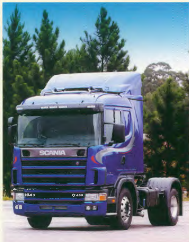
Modelo: 164 G 4x2 Entre-eixos: 3.550 mm Motor: DSC 16 02, 480 cv a 1.800 rpm PET: 18.200 kg PBTC: 66.000 kg
