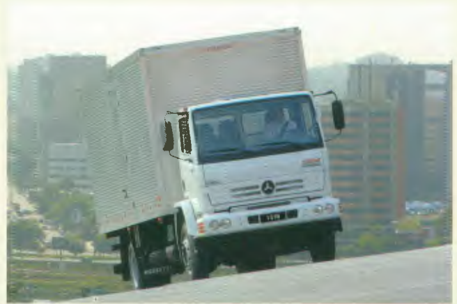
Modelo: 1318 4x2 Entre-eixos: 4.830 mm Motor: 170 cv a 2.300 rpm PBT: 21.300 kg
