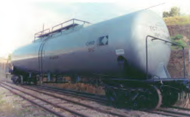
Vagão tanque destinado a derivados de petróleo e álcool
