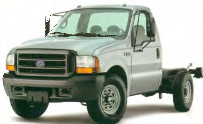
Modelo: F-350 4x2 Entre-eixos: 3.582 mm Motor: 141 cv a 2.700 rpm PBT: 4.500 kg
