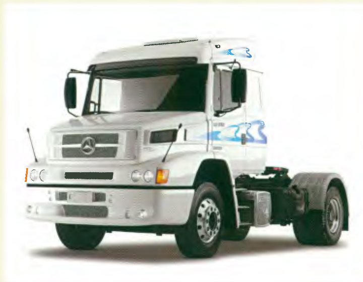
Modelo: LS 2638 6x2 Entre-eixos: 3.300 mm+1.295 mm Motor: OM 457 LA, 330 cv a 1.900 rpm PBT: 23.000 kg PBTC: 45.000 kg
