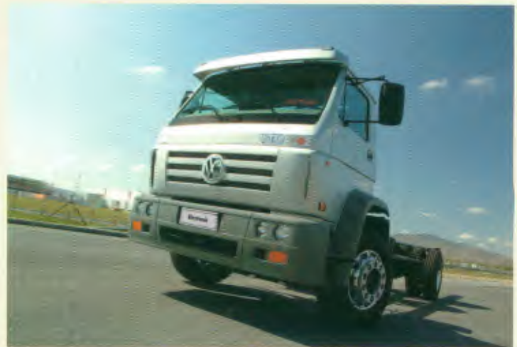
Modelo: 15.170 E 4x2 Entre-eixos: 3.560 mm/4.340 mm, 4.800 mm/5.207 mm Motor: Cummins Interact 4.0, 170 cv a 2.500 rpm PBT: 14.500 kg
