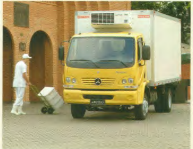
Modelo: Accelo 915 C Entre-eixos: 3.700 mm Motor: 152 cv a 2.300 rpm PBT: 9.000 kg
