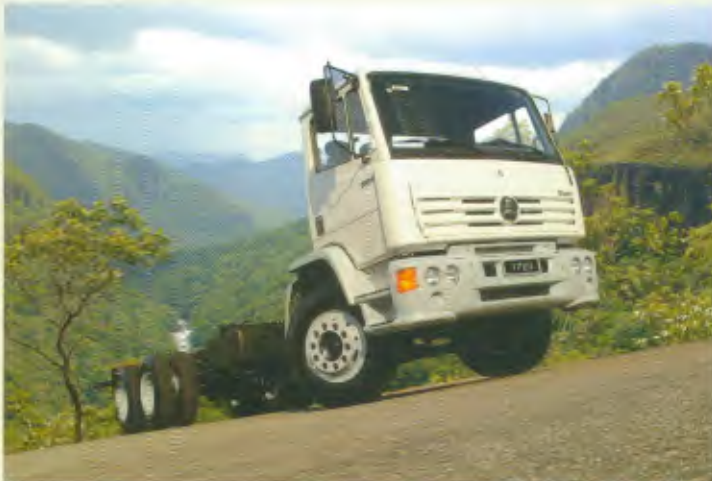
Modelo: 1720 6x2 Entre-eixos: 4.830 mm+1.360 mm Motor: OM 366 LA, 211 cv a 2.600 rpm PBT: 23.000 kg
