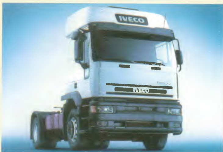
Modelo: EuroTech 4x2 Entre-eixos: 3.500 mm Motor: 370 cv a 1.900 rpm PBT: 16.000 kg
