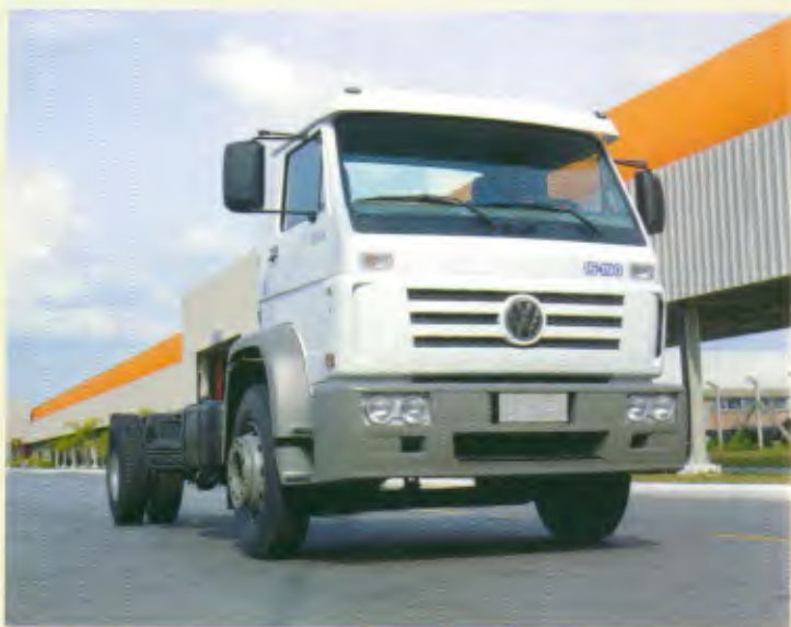
Modelo: 15.190 4x2 Entre-eixos: 3.560 mm/4.340 mm/ 4.800 mm/5.207 mm Motor: Cummins 6BTAA, 192 cv a 2.600 rpm PET: 14.500 kg
