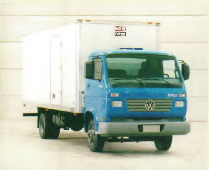
Modelo: 15.180 4x2 Entre-eixos: 3.560 mm, 4.340 mm, 4.800 mm, 5.207 mm Motor: MWM 6.10TCA, 180 cv a 2.800 rpm PBT: 14.500 kg
