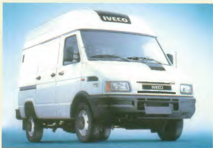
Modelo: Daily City 35 10 4x2 Entre-eixos: 2.800 mm, 3.300 mm Motor: Iveco 2.8, 103 cv a 3.600 rpm PBT: 1.560 kg, 1.690 kg, 1.730 kg
