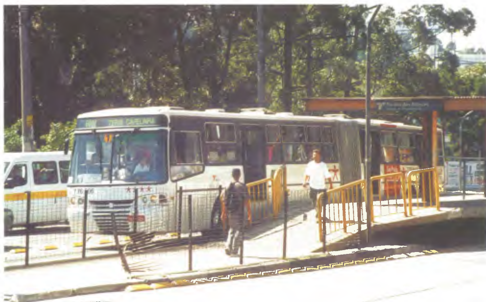
Corredor com plataforma elevada e ônibus com portas do lado esquerdo: uma solução barata e eficiente em meio ao caos paulistano
