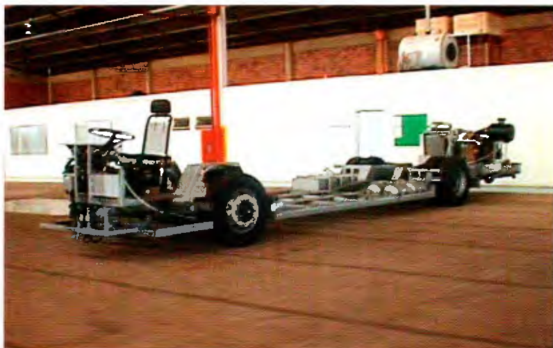
Chassi 105, piso baixo, com motor Cummins de 217 cv e pbt de 20,2 toneladas
