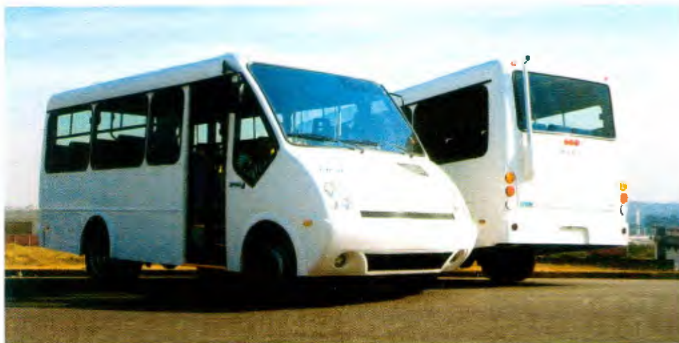
Attuale Bus, com 6,7 m de comprimento, para transportar de 15 a 25 pessoas
