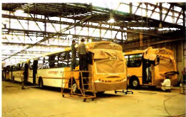
Linha de montagem da Induscar/Caio em Botucatu (SP): 22 carrocerias por dia
