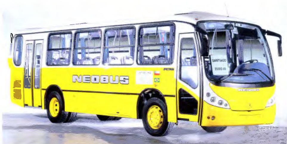
O chassi OH 1417 para 15 t aceita carrocerias de até 11 m de comprimento
