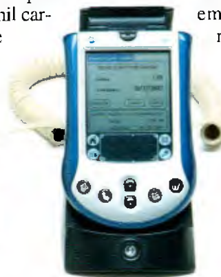
Terminal POS offline, que pode ser conectado a palmtop, para carregar smartcards com ou sem contato
