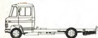
Chassi com cabina, que pode receber carroçarias para as mais diferentes finalidades. Distâncias entre-eixos de 2,95m e 3,50m.
