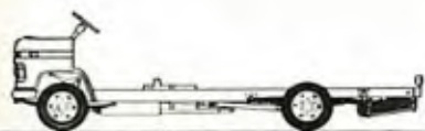
Chassi com frontal sem pára-brisas, versão básica para micro-ônibus. Distâncias entre-eixos de 2,95m, 3,50m e 4,10m.
