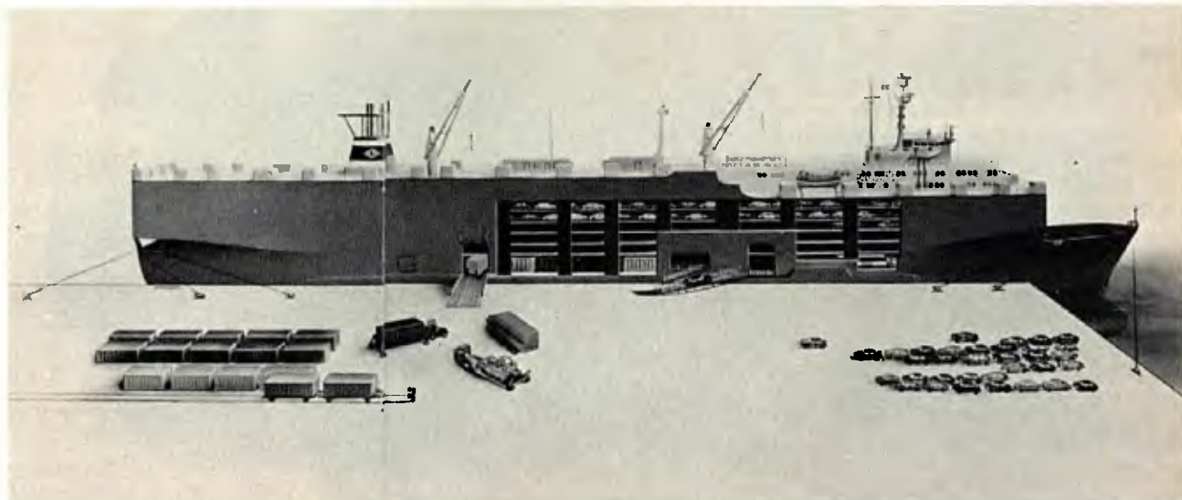
Os navios roll-on-roll-off não transportam apenas automóveis, mas também contêineres e carretas.
