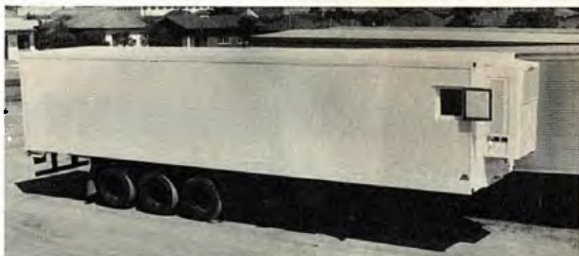
O novo semi-reboque Allplastic, da Recrusul, fabricado em plástico reforçado com fibra de vidro, permite transportar 1,5 t a mais.
