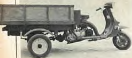
Triciclo BP-S-175: com capacidade para 300 kg de carga, transporta do pão ao jomal.
