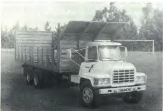
O veículo tem cabina individual em fibra
