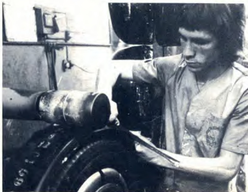
A aplicação do camelback exige atenção para se obter boa centragem.
