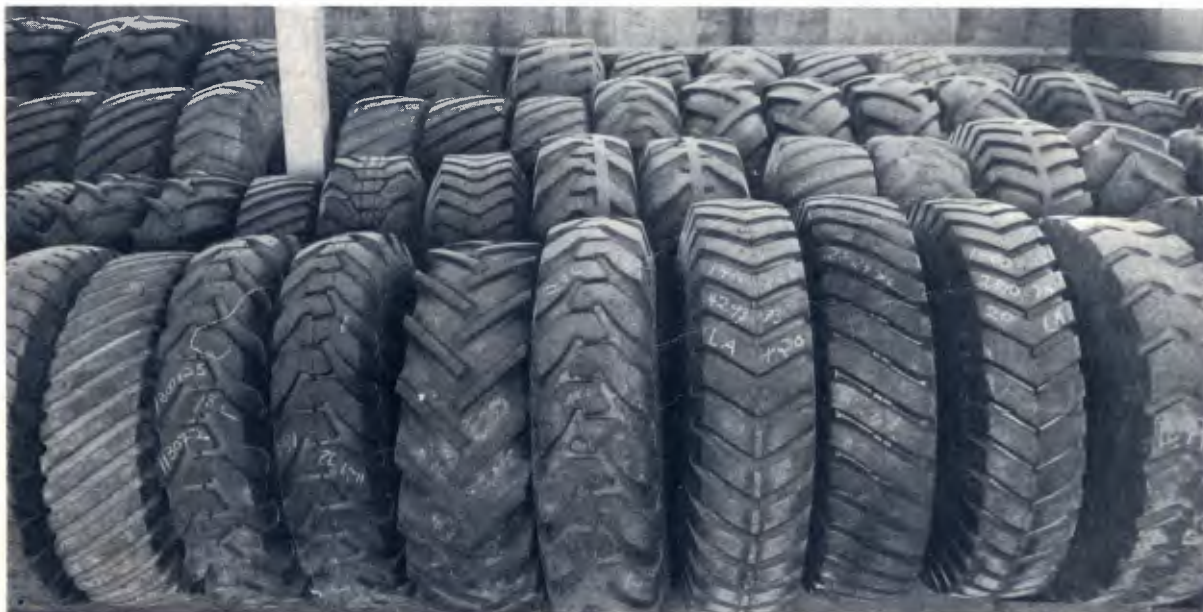
Os pneus de tração, a não ser em casos especiais, não devem ser utilizados nas rodas dianteiras dos veículos.
