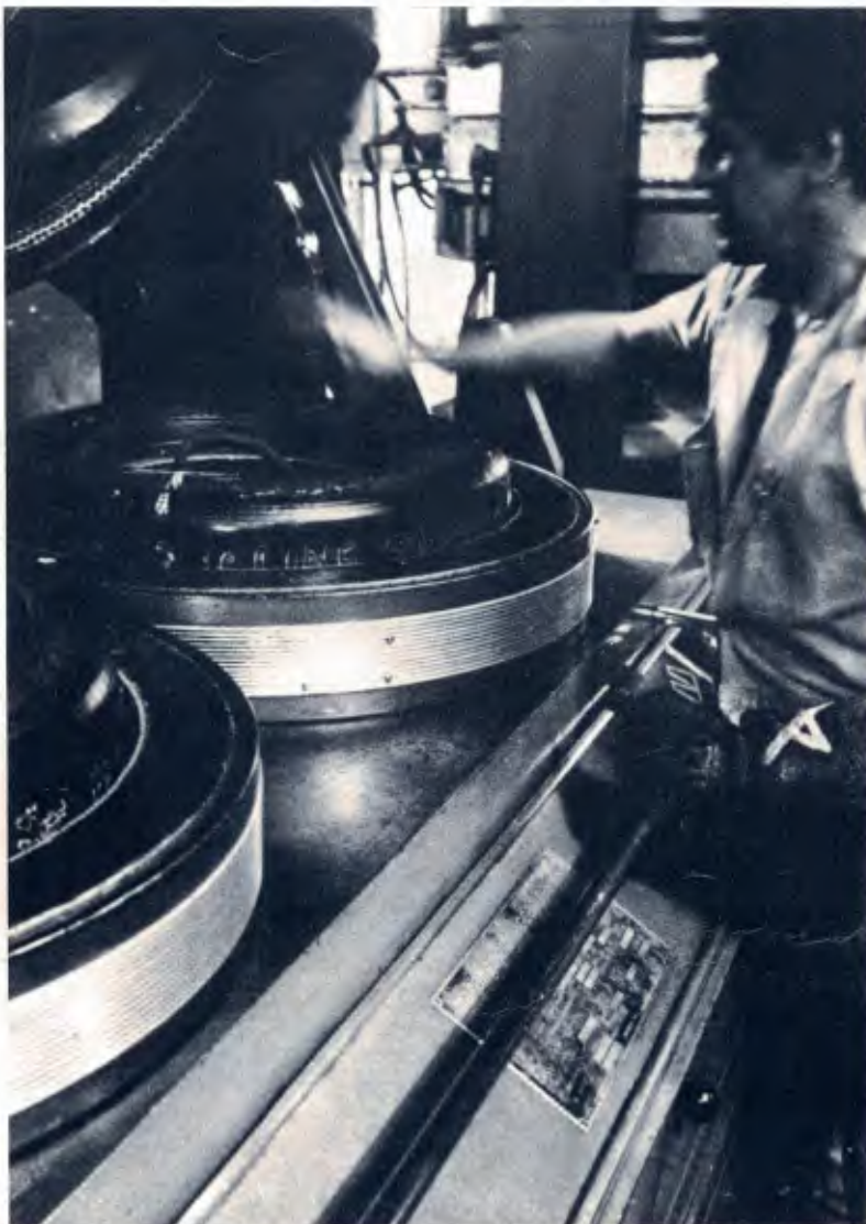
O pneu é vulcanizado numa câmara de vapor a alta pressão e temperatura.
