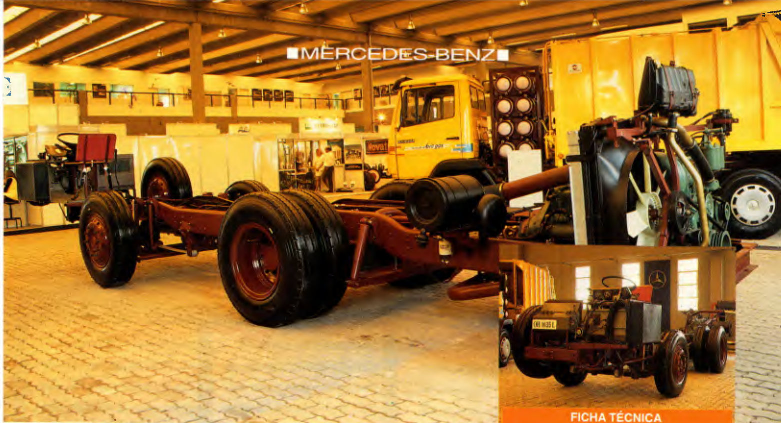
Motor OM-447 LA com turbocooler equipa o novo Mercedes
