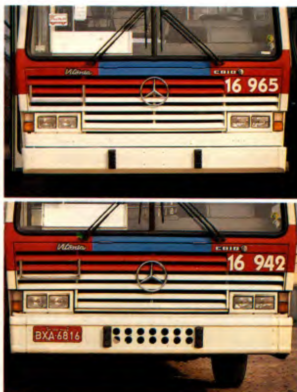
Pára-choque com chapa virada, em vez de nervuras
