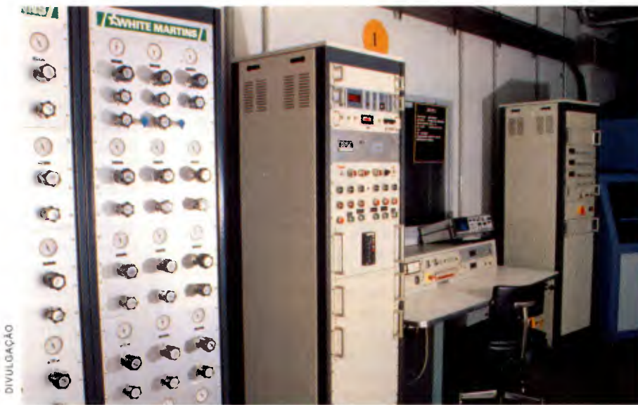
Estação de análise de emissões para adequar os motores ao mercado
