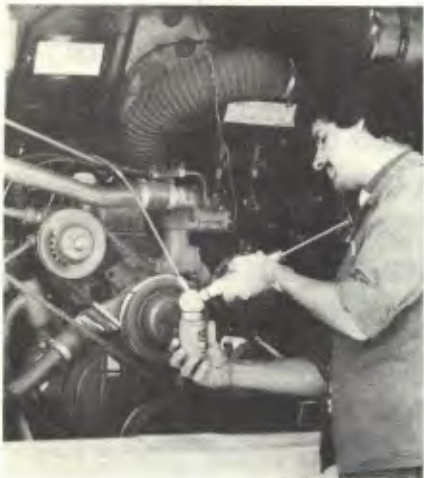
O óleo é coletado para análise do motor.
