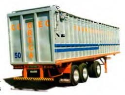
Semi-reboque para movimentar cargas de baixo peso específico; abaixo detalhe do piso móvel em alumínio sobre mancais de plástico
