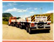
O Conjunto Treminhão Carga Seca, da Lider, com 23 m de comprimento, é formado por cavalo Mercedes, tração 6x4, e dois semi-reboques, com estrutura inferior composta por longarinas em perfil de seção I, intercaladas por travessas duplas de seção
