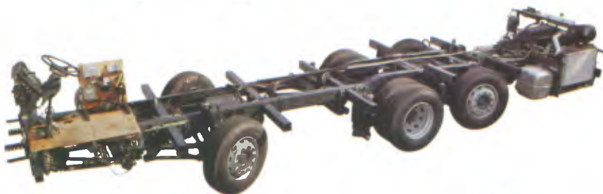
Scania K-270 permite carroceria de 15 m e possui terceiro eixo direcional
