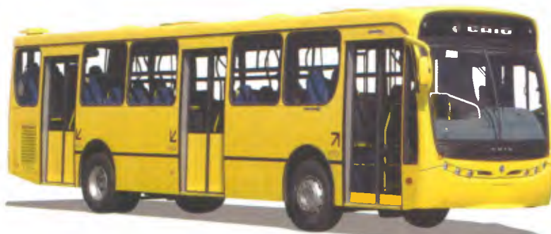
Modelo Apache S22, da Induscar-Caio: degraus de acesso mais amplos e balaústres com curvas suaves e ergonômicas
