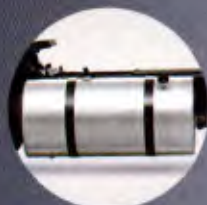
Novo tanque de alumínio de 480 litros.
