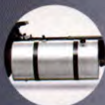
Novo tanque de alumínio de 480 litros.
