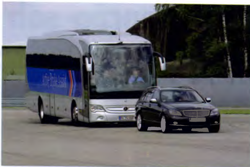
A Frenagem Ativa entra em ação na iminência de colisão com o veículo da frente
