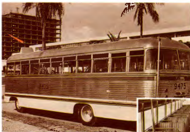
A primeira série de urbanos já com capelinha e um detalhe importante: o posicionamento dos bancos, um para cada janela, que tinha bandeira fixa superior
