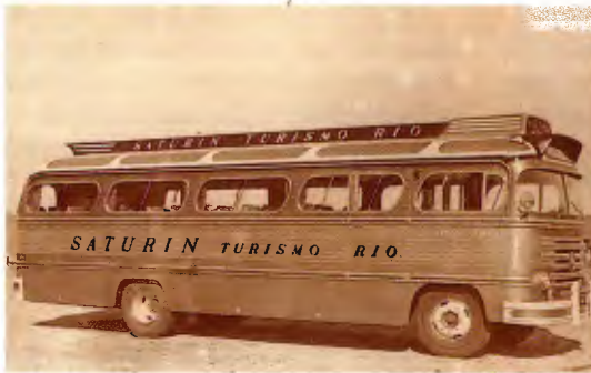
Modernidades da década de 50. Ventilação forçada e ombro do teto em acrílico para ônibus de turismo
