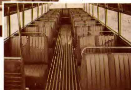
A primeira série de urbanos já com capelinha e um detalhe importante: o posicionamento dos bancos, um para cada janela, que tinha bandeira fixa superior
