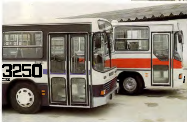
Portas largas otimizam transbordos; lateral tem aparência mais robusta. Esquadrias e bandeira fixa diminuíram, mantendo nível de ventilação
