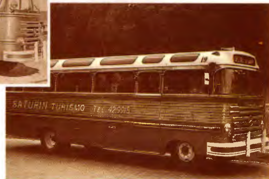
Modernidades da década de 50. Ventilação forçada e ombro do teto em acrílico para ônibus de turismo
