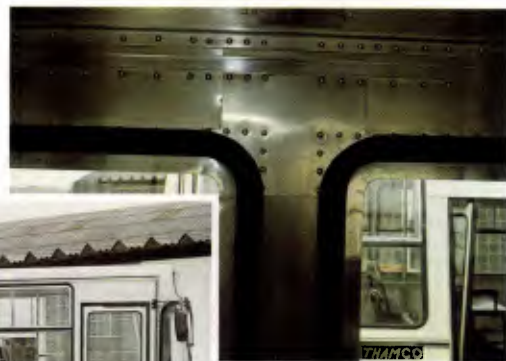
Portas largas otimizam transbordos; lateral tem aparência mais robusta. Esquadrias e bandeira fixa diminuíram, mantendo nível de ventilação
