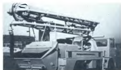
Esta bomba eleva concreto a 200 m.
