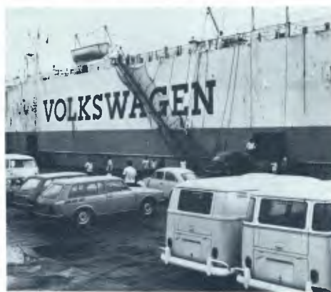
No navio ou no vagão, o ro/ro acelera a carga e a descarga dos veículos.
