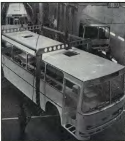
O moderno sistema de pintura do 0-364, na fábrica de Campinas.
