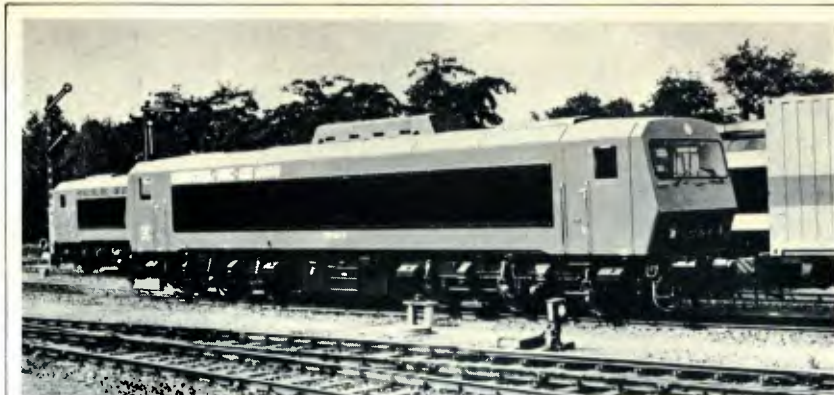
A DE 2 500 funciona como locomotiva diesel/elétrica ou somente elétrica e pode ser empregada para cargas e transporte rápido de passageiros.
