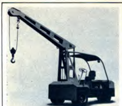
O K-110 vem equipado com diésel Perkins de 43,5 cv a 2 400 rpm
