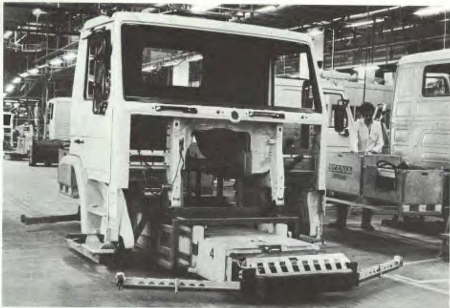
Robôs acionados por controle remoto e orientados por guias levam as cabinas
