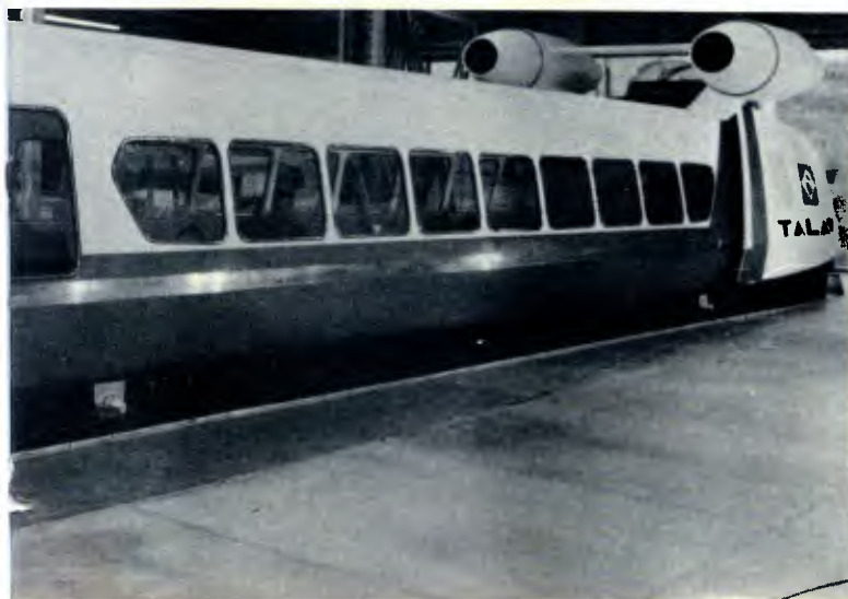
O Talav, um trem leve de alta velocidade, desenvolvido pela FEI, será utilizado pela primeira vez na Fepam. Com um custo aproximado de Cr$ 3 milhões, será movido a turbina, deslocando-se sobre um colchão de ar.
