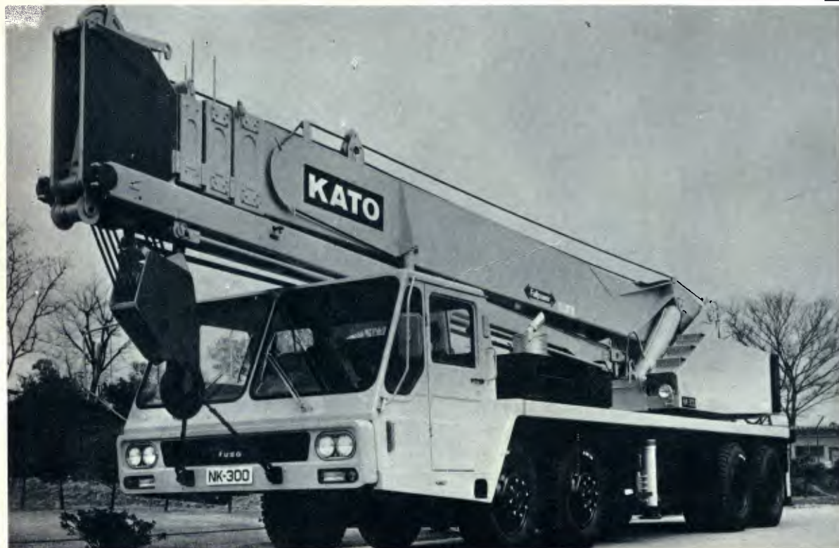
A Kato levará ao Anhembi a versão "300" de seus guindastes hidráulicos sobre rodas, da linha "NK", para 35 toneladas
