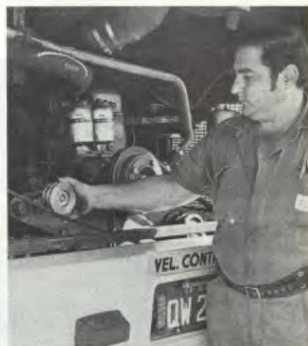
Outro detalhe foi observado através da utilização desta invenção: a impossibilidade da polia ficar adaptada permanentemente ao motor. Segundo o chefe de manutenção da empresa, a permanência acarretaria a "solda" das esferas, impossibilitando a utilização do sistema.
