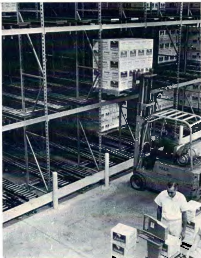
Os pallets deslizam sobre roletes.
