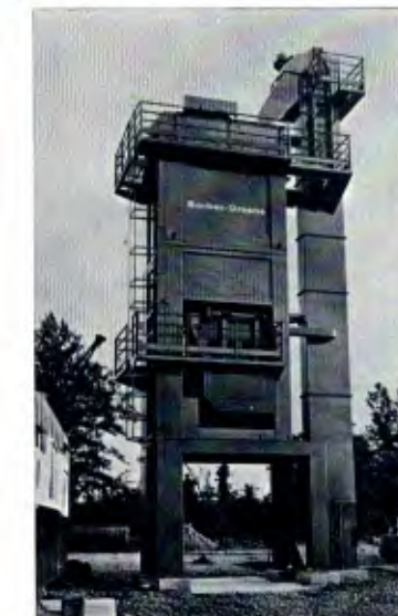
A torre de usina de asfalto gravimétrica será uma das atrações da Barber-Greene. A outra será uma carreta de britagem.
