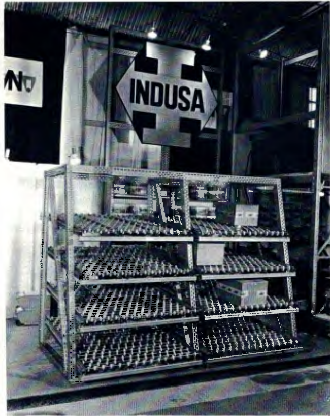
Flow-rack: a estocagem dinâmica.
