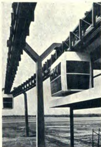
Suspensos por cabos ou correndo entre guias, ao nível do solo, os sistemas de transporte rápido de massa foram a grande atração da Transpo 72. Funcionam quase como gigantesco elevadores automáticos, operando na horizontal. O passageiro só precisa apertar um botão.
