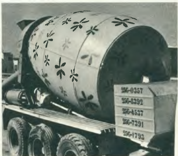
Betoneira gigante, montada sobre chassi Scania com três eixos, tem capacidade para 7 m 3 de concreto.
