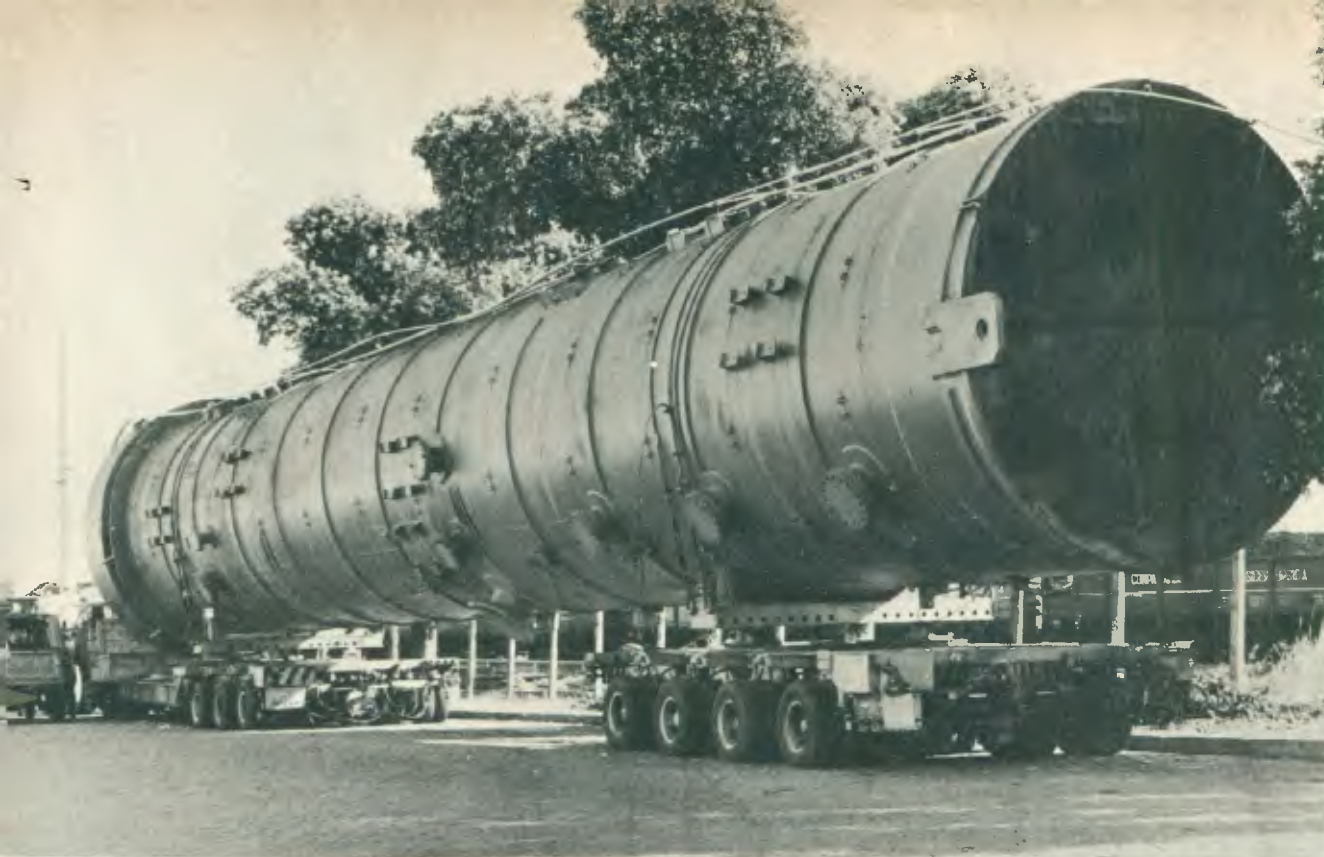
Recorde em largura: remoção de tanque de 12 m de diâmetro exigiu a utilização de duas carrêtas geminadas.
