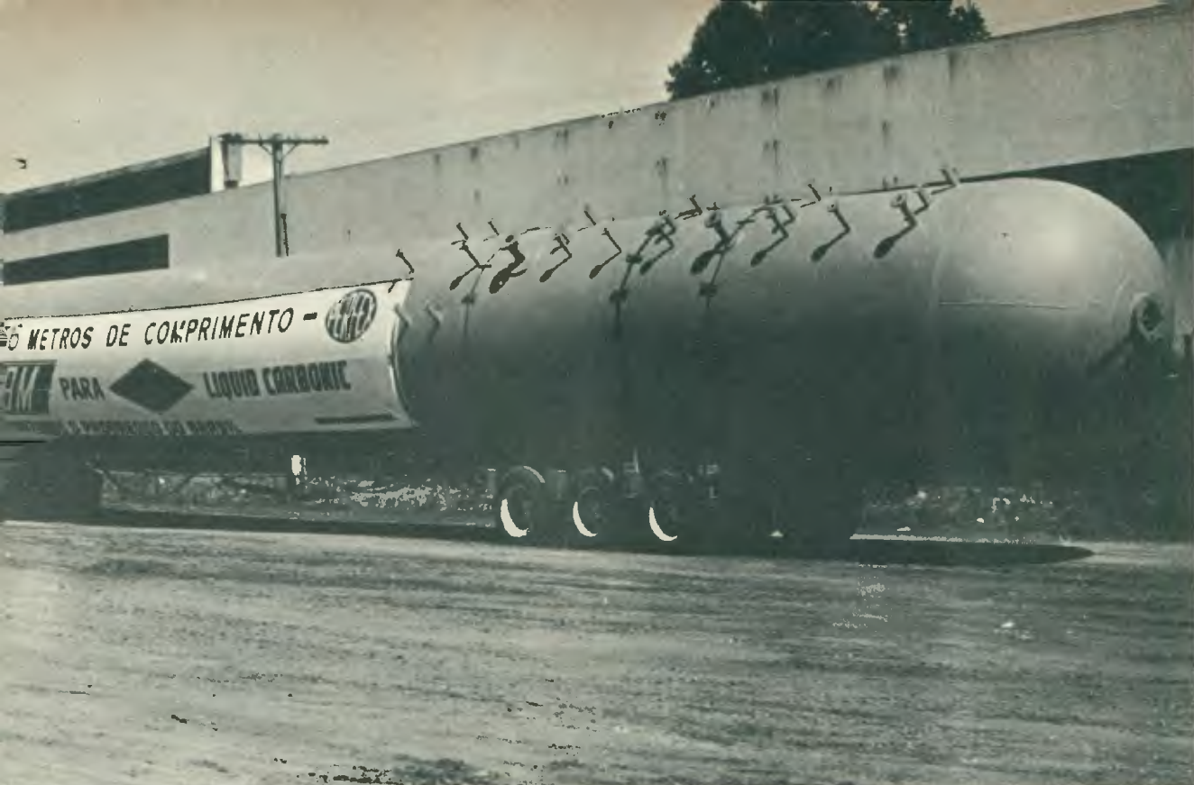
adequado: este tanque, de 26 m de comprimento e 86 t de peso, foi transportado para a Liquid Carbonic.
