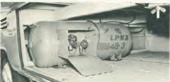
Pickup a GLP permite taxa de compressão de até 12:1. Para adaptar, basta instalar o cilindro-tanque, o vaporizador e modificar ligeiramente o carburador.
