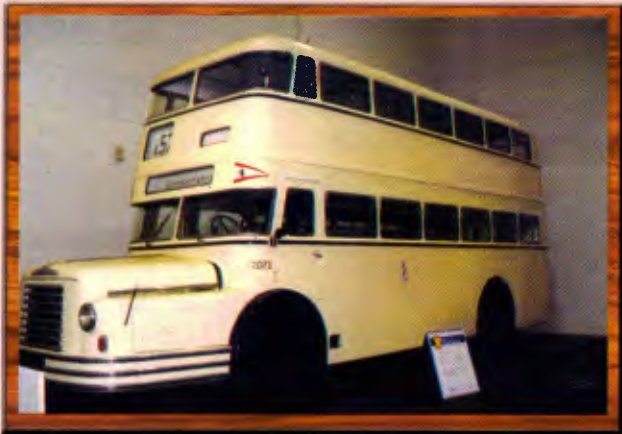
Waggonbau Bautzen DO 56, Double Decker, de 1956, para 52 passageiros, com 9,80 m de comprimento
