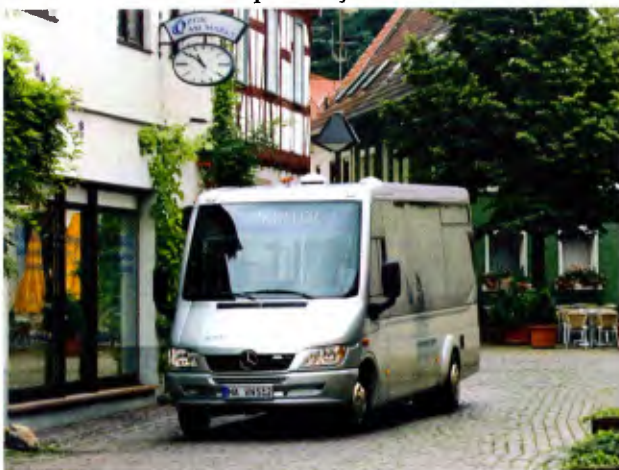
Minibus de piso baixo, com chassi Sprinter
