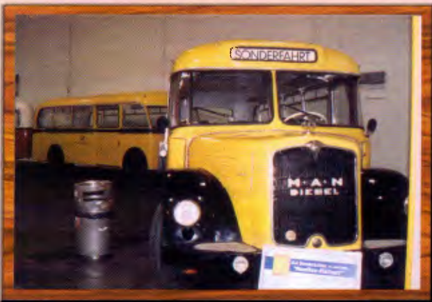
Man MKN26, articulado, a diesel, ano 1953 para 34 passageiros, com 10,18 m de comprimento
