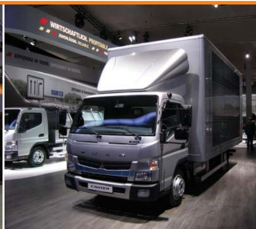
o fluxo de ar otimizado em torno do boque. Como resultado, melhora muito o coeficiente de resistência ao arrasto.
