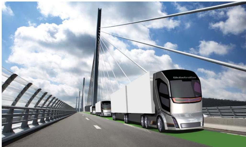
**Ilustração do sistema de comboio de caminhões que permite reduzir o arrasto e o consumo**
