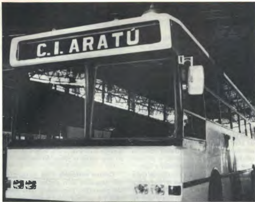
Incabasa para exportação: 12,60 m, motor Detroit a álcool e transmissão automática.
