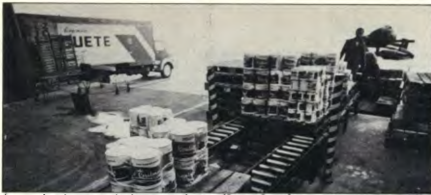
A mesa de roletes motorizados que conduz os paletes até o início da carroçaria do caminhão
