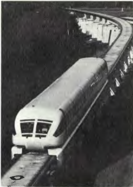
O Transrapid movimenta-se através de impulsos elétricos sobre um colchão eletromagnético
