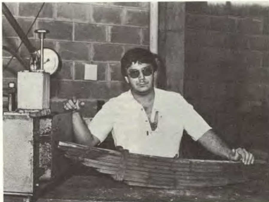
Pereira: não se pode arquear a mola mais de três vezes, pois o aço fica mole
