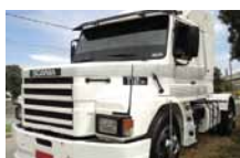
1980 Intercooler, cabine com estrutura de sobrevivência, pneu radial sem câmara
