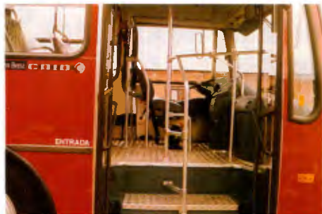
Motor traseiro: uma fonte de espaço interno junto ao motorista
