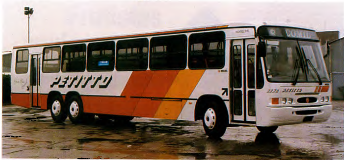
Svelto, com 14 m de comprimento, transporta 50 passageiros sentados e 51 em pé
