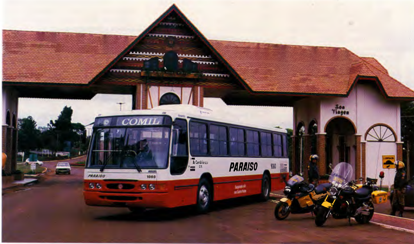
Svelto, com 12,30 m de comprimento, portas estreitas e vidros lacrados para evitar a dispersão do ar condicionado
