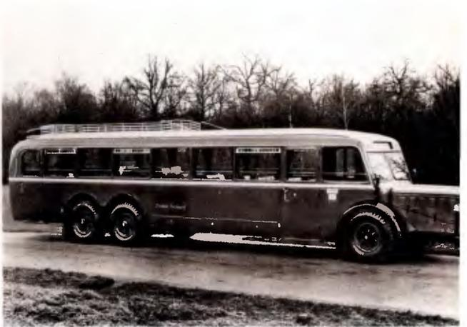
Superfocinhudo com três eixos, o O-10.000 tinha 54 lugares, motor de 150 cv e atingia 65 km/h
