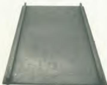
Correia transportadora com proteção lateral de borracha vulcanizada para evitar queda ou escape de material
