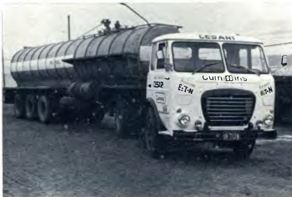
O aspecto externo não muda, mas o motor leva novos suportes e o capô é levantado quase 200 mm.
