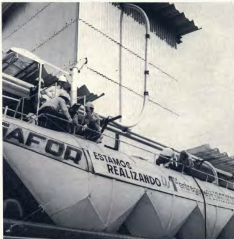
A carga pelo alto deve ser feita com as válvulas inferiores fechadas.
