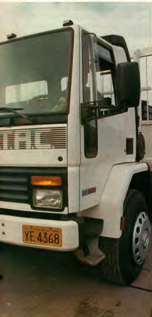
A cabina avançada dos caminhões Volkswagen e Ford Cargo possibilita o acréscimo de uma tonelada sobre o eixo dianteiro com o rearranjo da carga, sem desrespeitar o limite estabelecido para o eixo traseiro
