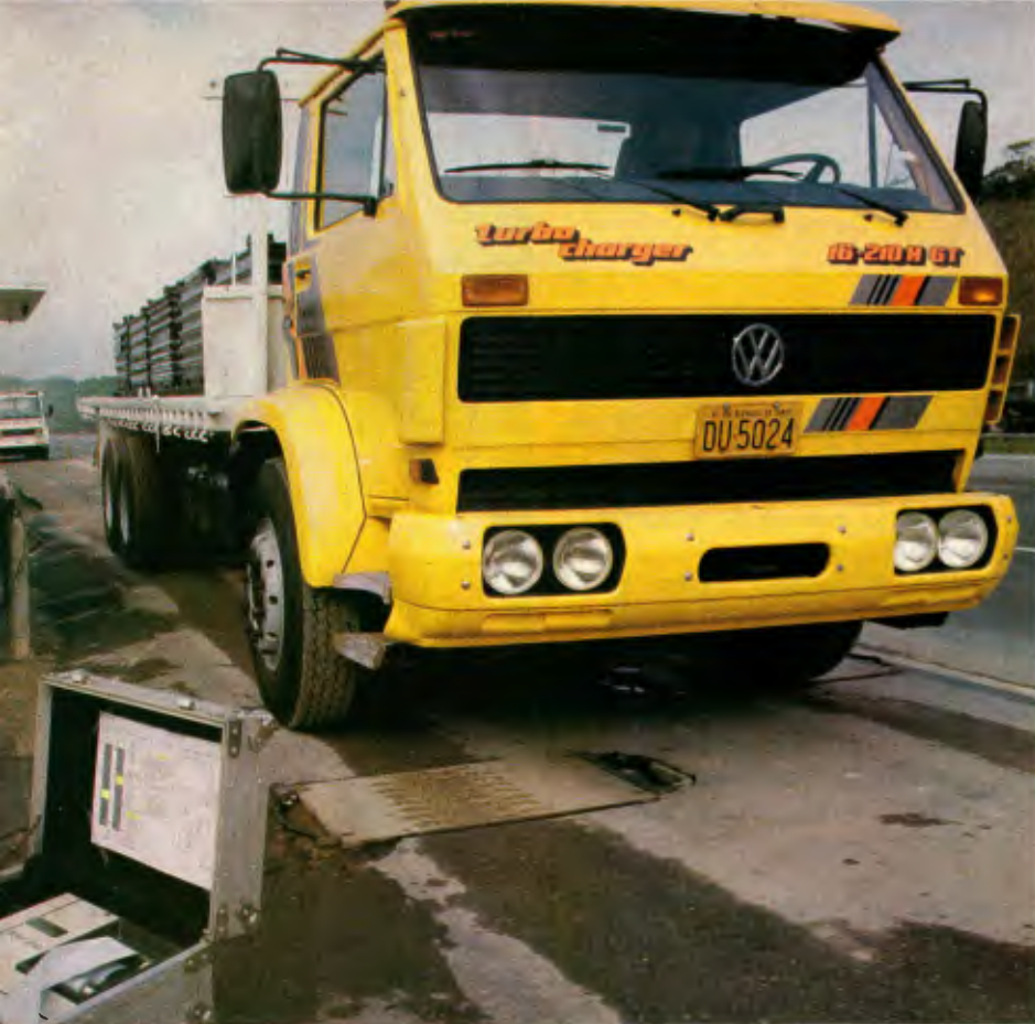
A cabina avançada dos caminhões Volkswagen e Ford Cargo possibilita o acréscimo de uma tonelada sobre o eixo dianteiro com o rearranjo da carga, sem desrespeitar o limite estabelecido para o eixo traseiro
