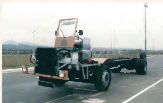
VW 16.210 CO, o segundo chassi mais vendido em 2000, com motor MWM turbo e aftercooler, para transporte urbano e fretamento
