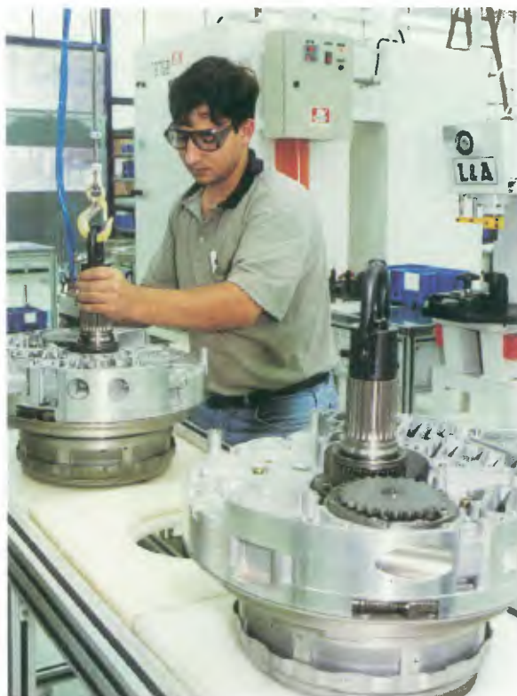
Banco de teste final ligado diretamente à Alemanha, via Internet, para controle de qualidade da caixa Ecomat
