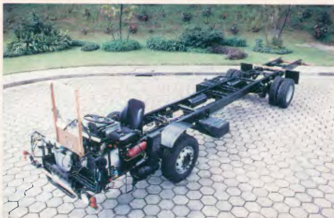
MB OF-1721, líder de vendas, de tamanho convencional, com motor MB OM-366 LA turbocooler, Euro II e PBT de 17.000 kg, para carrocerias de 2 ou 3 portas
