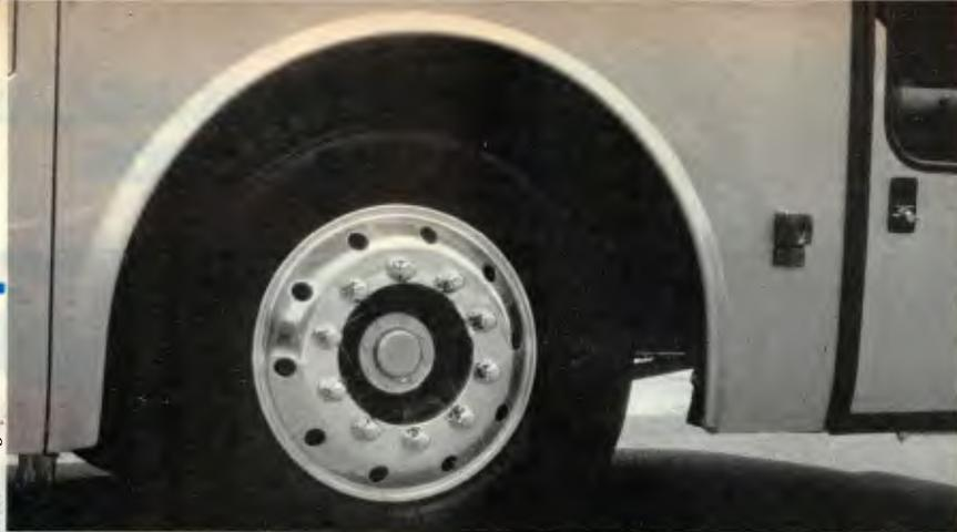
As rodas recebem um tratamento térmico que assegura resistência superior à do aço
