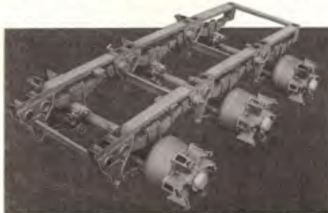
Suspensão "sliding" - exclusividade FNV-Fruehauf que permite o ajuste dos eixos conforme o peso da carga, proporcionando estabilidade e segurança.
