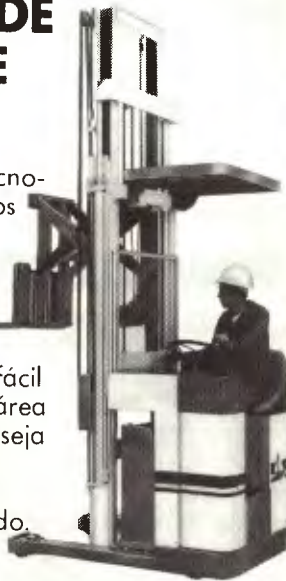
Empilhadeira Pantográfica Capacidade: 1800 kg
