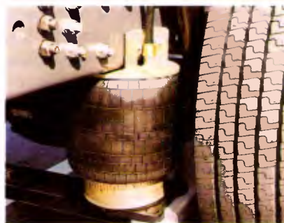
No modelo 17.240 OT, a suspensão pneumática traz bolsões de ar (detalhe) que impedem movimentos laterais, propiciando conforto
