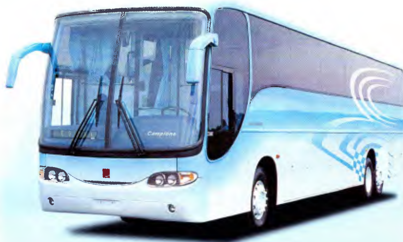
A linha Campione ganhou externamente novo frontal, pára-choques, espelhos retrovisores, opção de pára-brisa inteiriço e, por dentro, agora, a iluminação é no teto. A cabine do motorista também é nova
