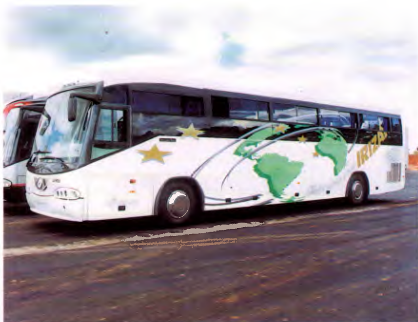
Intercentury: uma carroceria para ser instalada em todas as plataformas e chassis disponíveis, com opções de 12 m, 12,85 m e 14 m de comprimento
