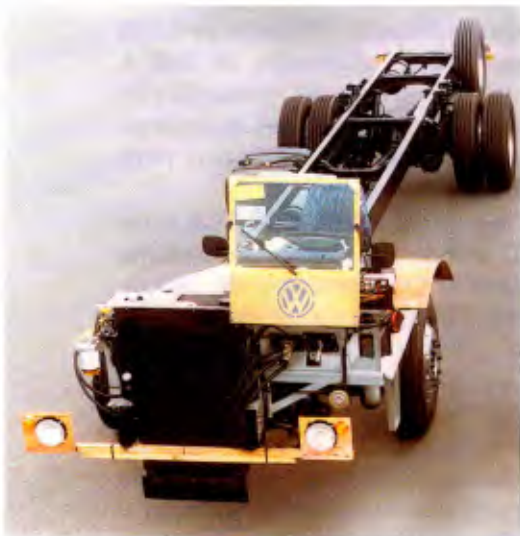
No chassi do ônibus 17.210 OD, o mecanismo de corte de combustível por cabo foi substituído por válvula solenóide
