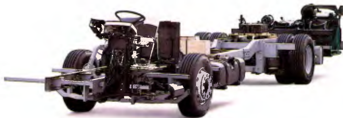
Chassi O 500 M, para carroceria de 12 m a 13,2 m, destina-se a aplicações múltiplas
