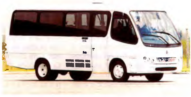
O minibus 8.150 OD desenvolve 20% a mais de torque e 7% a mais de potência (145 cv) que o modelo anterior
