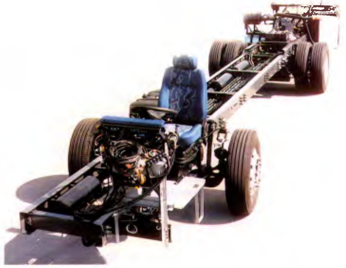
O chassi modular, na versão Boogie, atende ao serviço de fretamento ou rodoviário para encarroçamentos de até 12.800 mm, com distância entre-eixos de 3.000 mm
