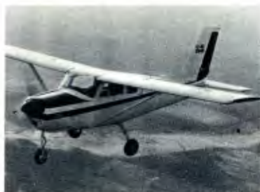
Regente C-42, na versão civil: asa baixa, lugares para três e quatro horas de autonomia a até 220 km/h.
