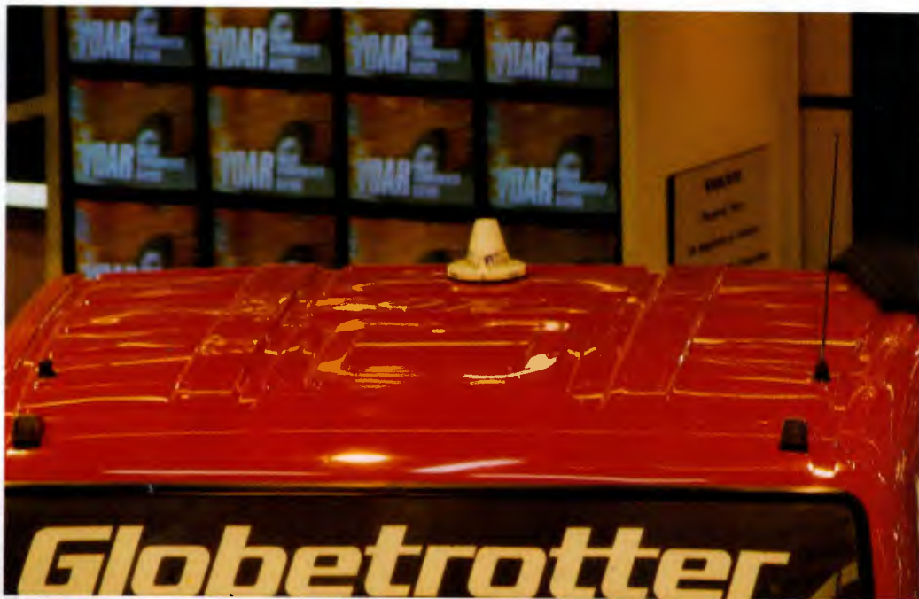
O segredo da comunicação com o satélite são as antenas sobre o veículo
