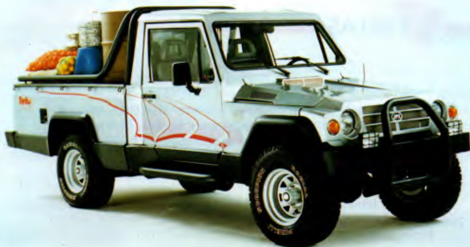
JPX 4x4: 1.050 kg de carga útil e tanque com autonomia para 800 km
