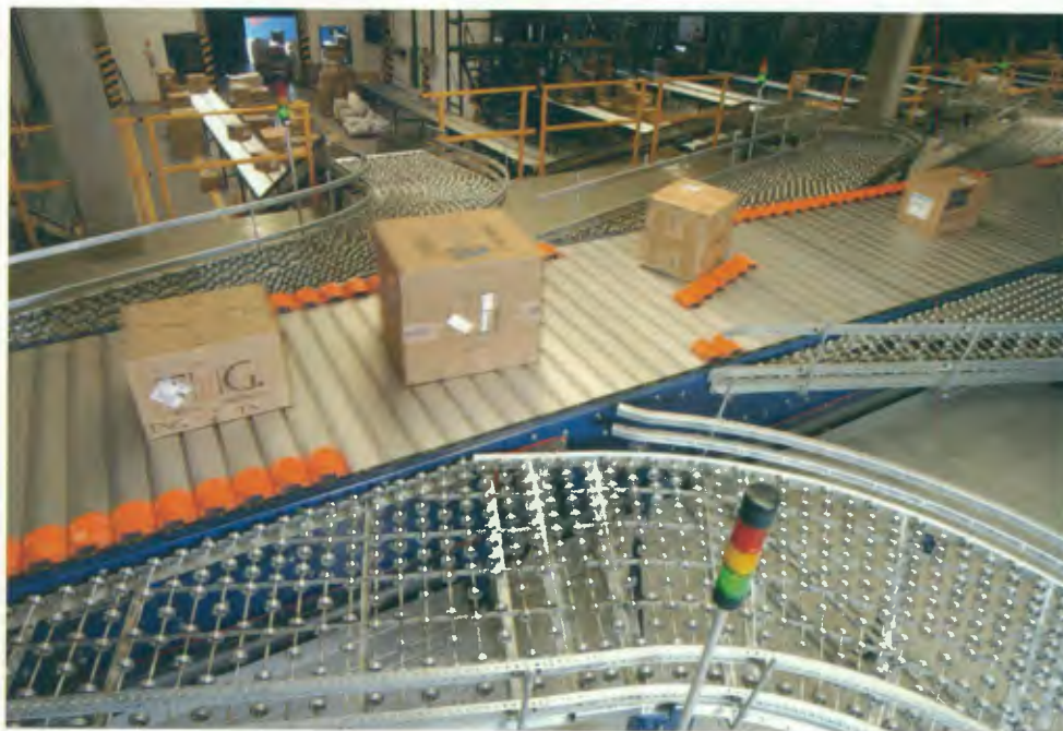
O sistema lê o código de barras da embalagem e a direciona automaticamente à doca de saída
